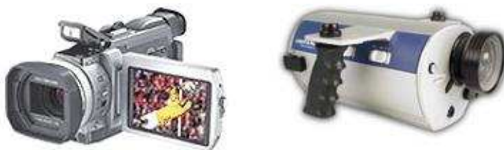
Cámara de vídeo y carcasa para grabaciones submarinas
