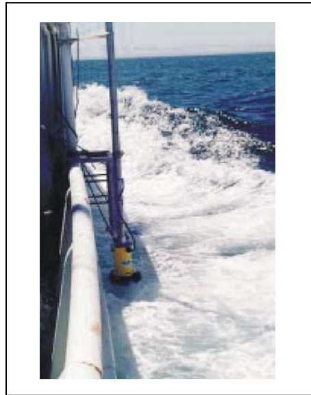
Correntímetro realizando una toma de datos de intensidad y dirección de la corriente en movimiento
