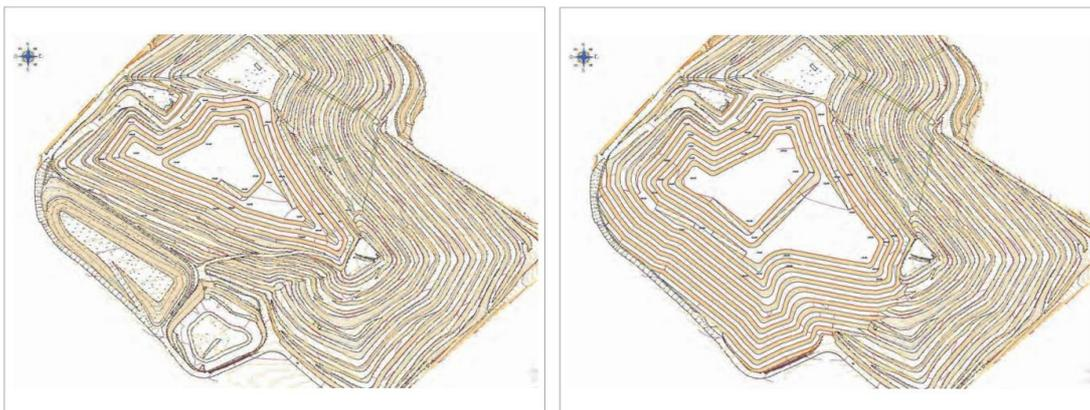
Fig. 2 Alternativa seleccionada para el recrecido de la celda 4.1 (izqda.) y 4.2 (derecha)
