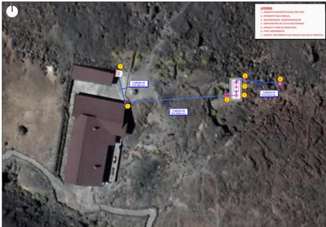
Figura 2. Vista aérea con disposición de los elementos que componen la depuradora
