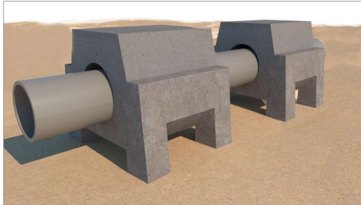
Figura 4. Infografía de la solución proyectada de los lastres de hormigón con patas y fondo biselado. Fuente: CIVILPORT Ingenieros, S.L.P.
