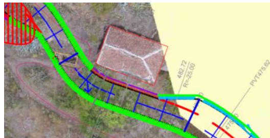
Detalle del trazado a la altura de la unidad patrimonial Leleta II, estimando la afección directa a la Gañanía existente semiderruida.
