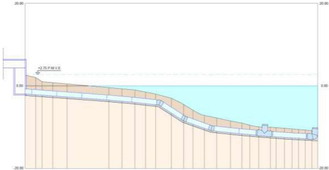
Perfil de la conducción de vertido (Fuente: Proyecto constructivo para la legalización de la conducción de vertido de la EDAR de Buenos Aires – INNCIVE).
